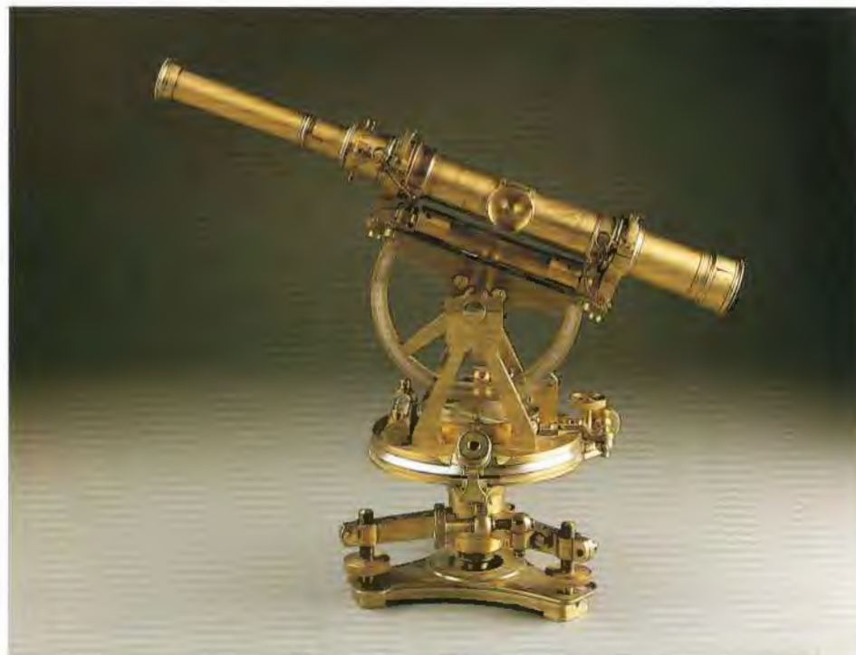
Averiguar la posición de una serie de puntos respecto a otros equivale a conocer las distancias que los separan y las figuras geométricas que se forman al unirlos entre sí. (Taquímetro Troughton.)
